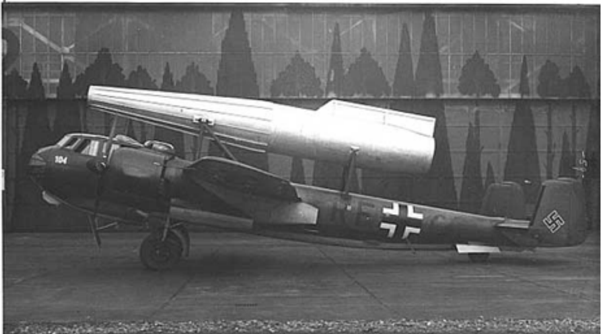
Abb. 25; 20000-RJ-Strahlrohr auf Do 217 E-2 als Versuchsträger, Seitenansicht.
